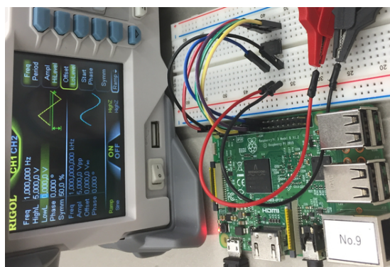
Fig. 2 RasPi3B と MCP3002 との接続写真
